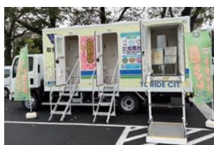
取手市災害用トイレトラック
